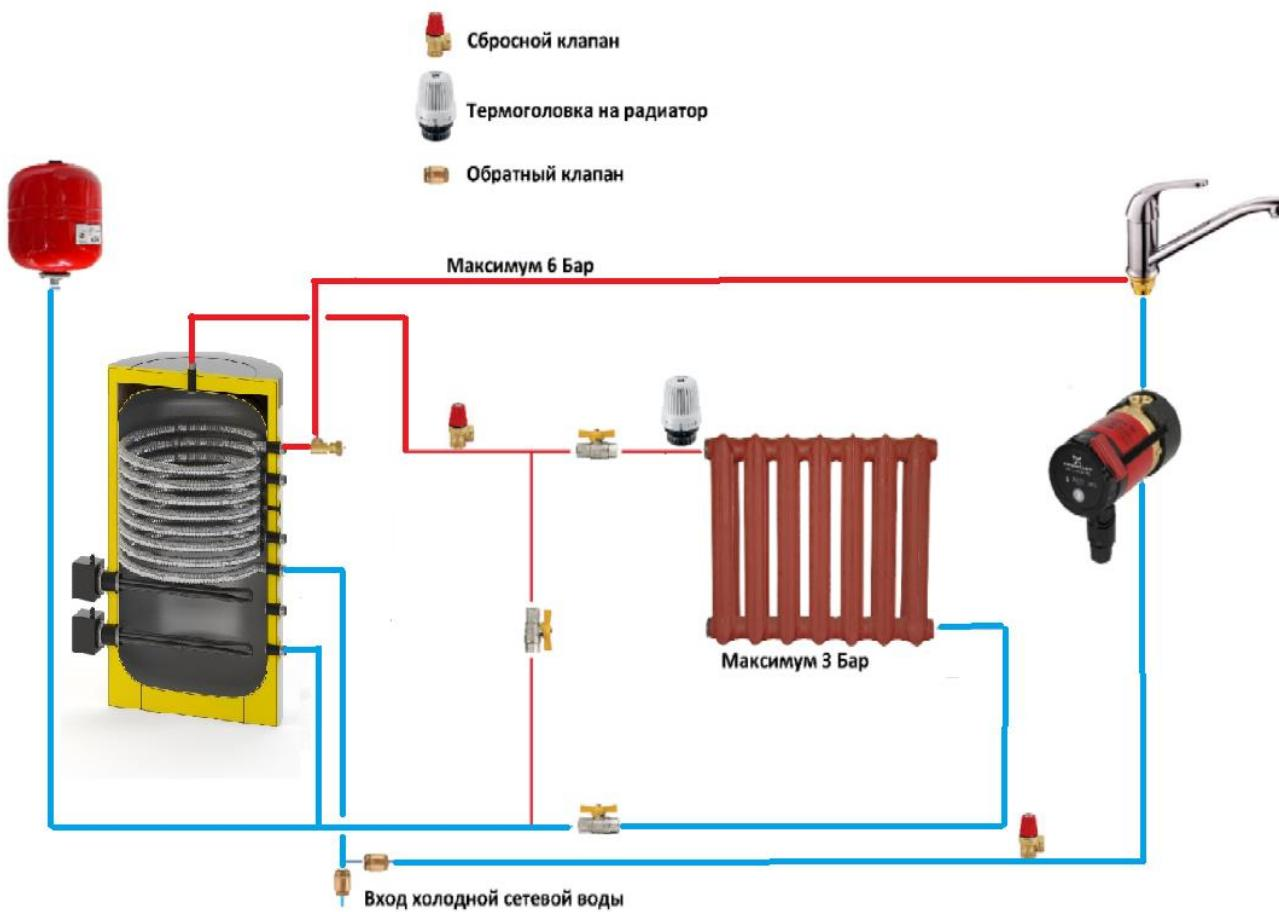
Схема с противоожоговым клапоном и рециркуляцией бака
