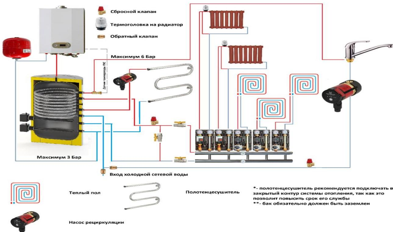
Данная схема реализована с применением возможности бака как гидравлического разделителя. Так же показаны различные возможности, связанные с подключением полотенцесушителя, рециркуляцией.
